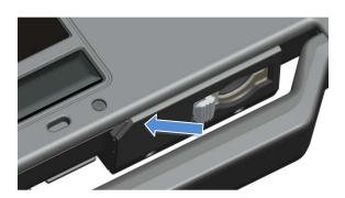
يمكن إدخال البطاقة الرقمية المؤمنة بالكامل، للسماح بغلق الباب الواقي. أدخل البطاقة في الفتحة الرقمية المؤمنة حتى تستقر تمامًا في الموصل الخاص بها. لتحرير البطاقة الرقمية المؤمنة، اضغط على حافة البطاقة وسيقوم القارئ بإخراج البطاقة.
